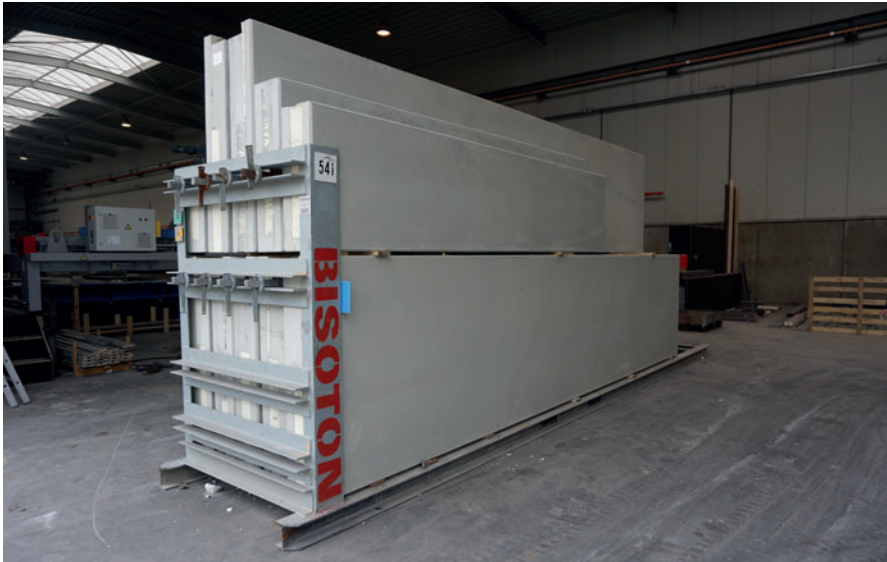
Fertige Sandwichelemente hergestellt mit dem BT-Schalungsträgersystem
