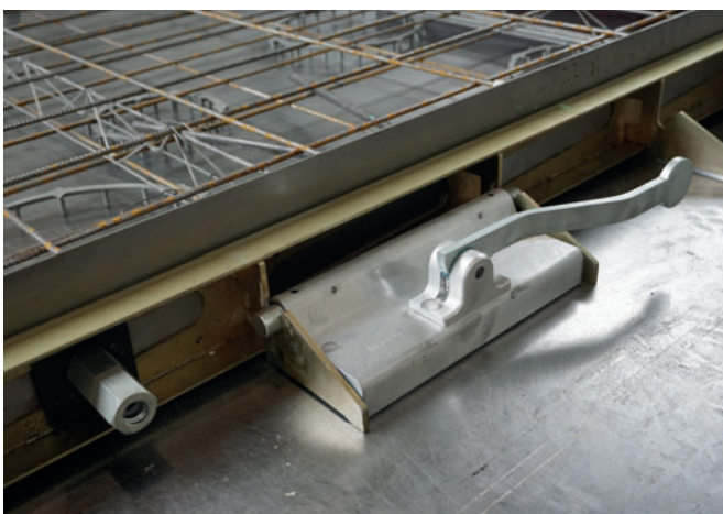
Verschraubtes Schalblech UniForm am MultiForm-Schalungsträger: Die Fixierung der Schalung erfolgte durch MagFly AP Magneten.
