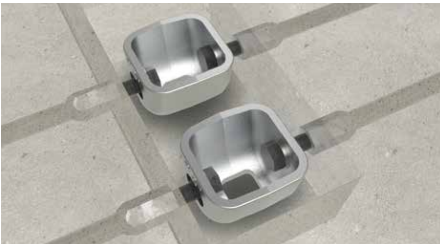
Bild 5: Perspektivische Darstellung der Ausführung des Ringankers mit dem BT-Spannschloss®
