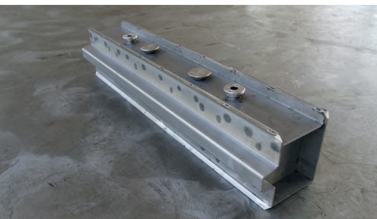
Coffrage massif spécial avec aimants intégrés et logement pour pinces de robot
