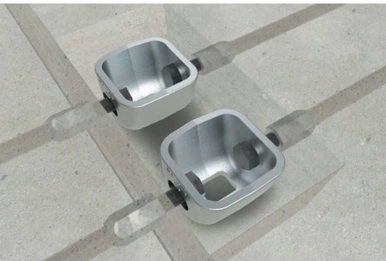
Соединение двух сборных железобетонных элементов (слева) и трех сборных железобетонных элементов (справа). Замки BT-Spannschloss устанавливаются на стройплощадке в заводские ниши с предусмотренными анкерными точками
