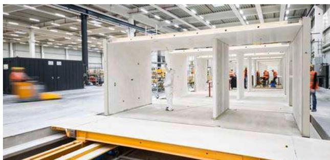
Línea de producción de módulos de sala maxmodul
