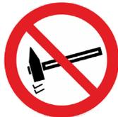
Ne pas utiliser de pied de biche ou tout autre outil pour retirer la peau de coffrage. Pour séparer la peau de coffrage de l'élément de coffrage MultiForm, il convient avec toute chose de dévisser par l'arrière les écrous Dywidag.
