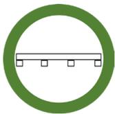
Lors du stockage et du nettoyage des tôles UniForm, il convient de veiller à ce que poids soit uniformément réparti, afin d'éviter autant que faire ce peu une déformation de la peau de coffrage.
