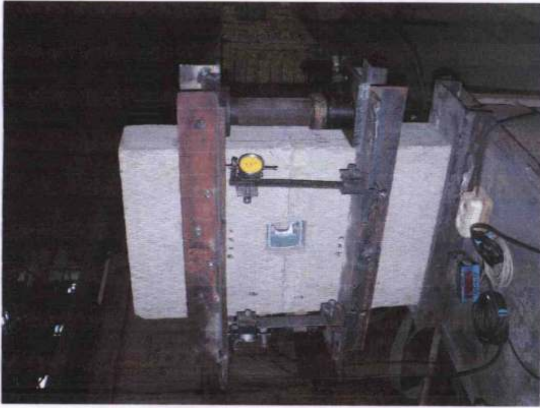
Рис. 3.2. Общий вид опытного образца, установленного в силовую раму.
