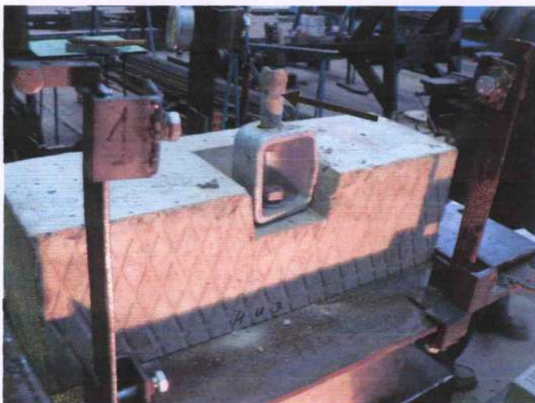
Рис. 3.5 Характер разрушения опытного образца при действии на связь растягивающего усилия.
