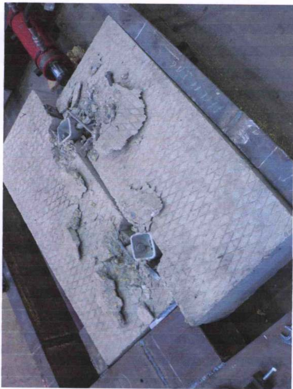
Рис. 4.8 Характер разрушения связей в 1-ом опытном образце.
