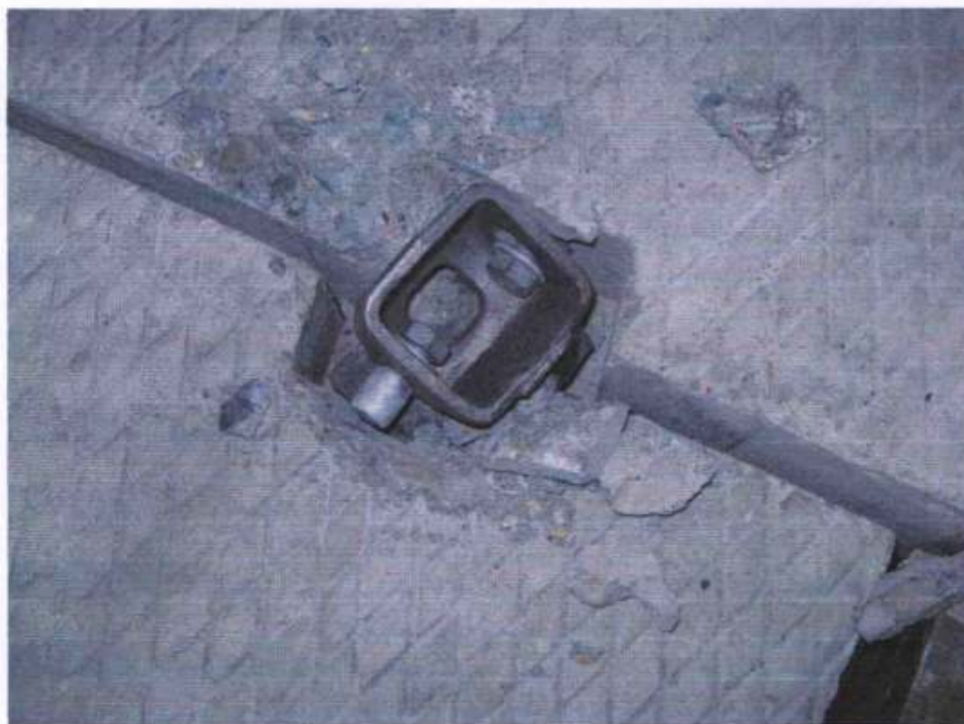
Рис. 4.12 Характер разрушения каждой из 2-х связей во 2-м опытном образце.
