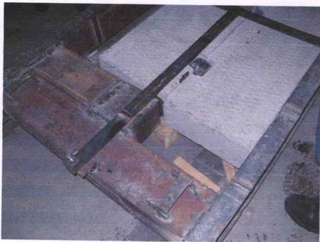
Рис. 4.11 Участки 2-го опытного образца в зоне установки домкрата (а) и в опорной зоне (б).
