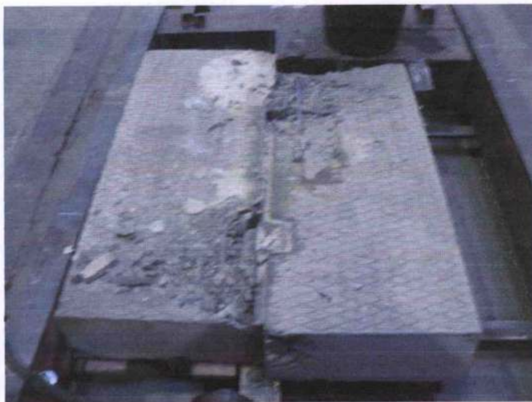
Рис. 4.14 Характер разрушения стыкового соединения 3-го опытного образца.
